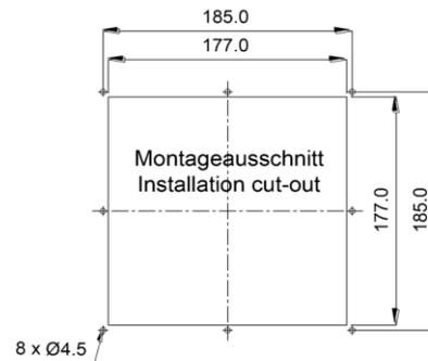
Bohrungen nur bei Schraubbefestigung
