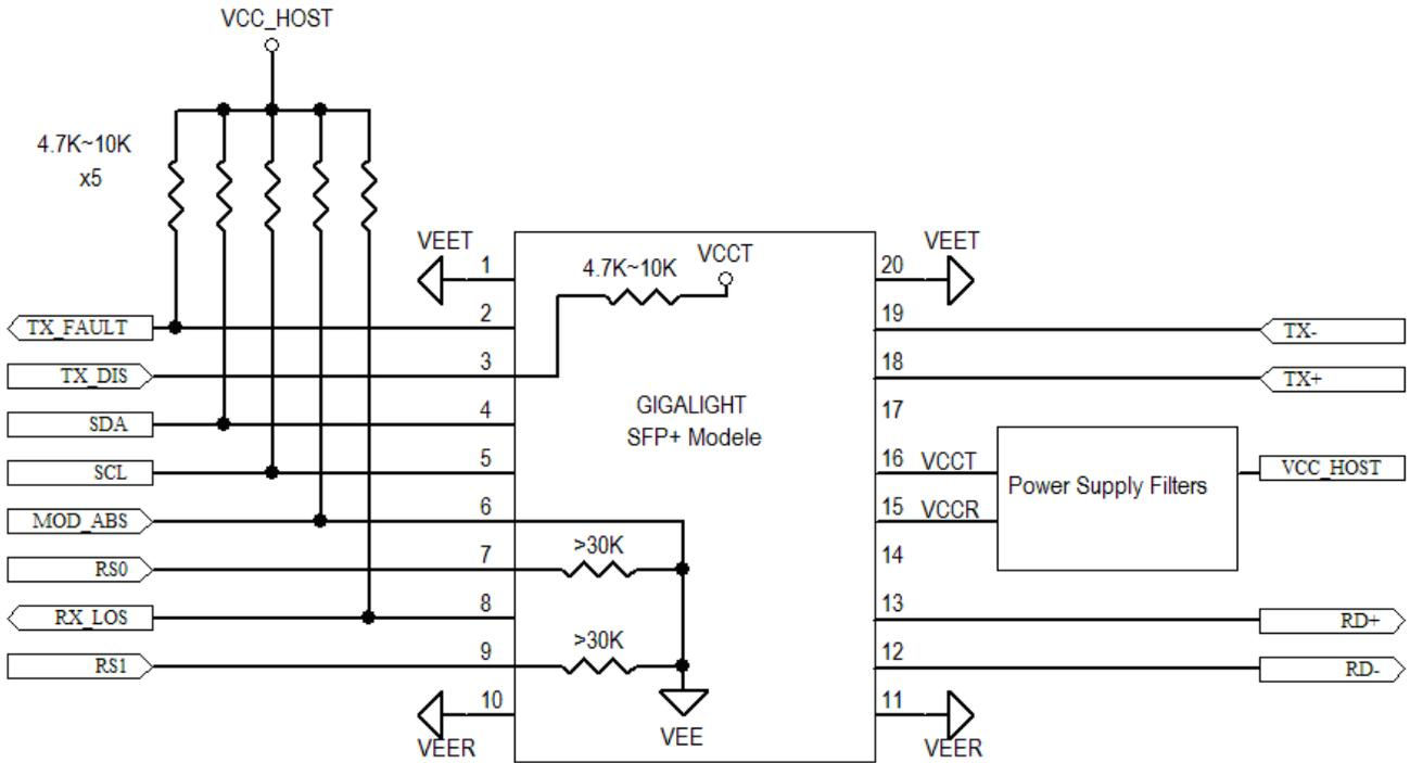
**Figure4. Host-Module Interface**
